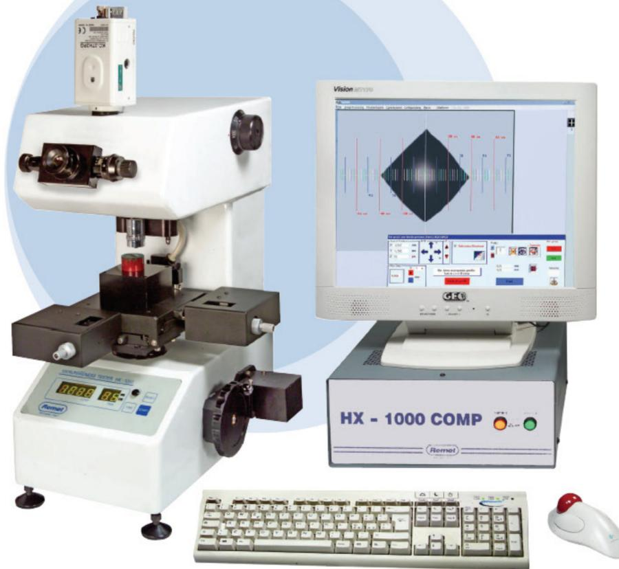
Sistema completamente automatico di misura della durezza Vickers e Knoop con tavola motorizzata nei tre assi x-y-z per la movimentazione del campione ed il controllo della messa a fuoco.
