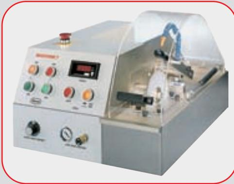
La MICROMET AUTOMATICA, costruita con una robusta struttura in acciaio inox, è dotata di sofisticate tecnologie di controllo della precisione del taglio che permettono di effettuare sezioni di campioni in automatico perfettamente riproducibili:
