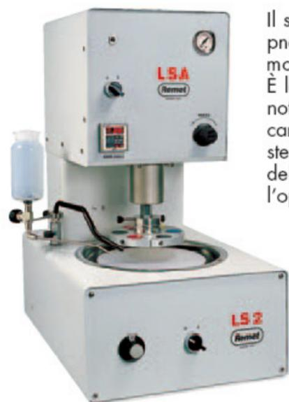
Il sistema automatico ad azionamento pneumatico può essere installato su ogni modello di pulitrice. È lo strumento indispensabile per abbattere notevolmente i costi di produzione dei campioni metallografici, garantendo allo stesso tempo una perfetta riproducibilità del risultato finale con minore fatica per l'operatore.
