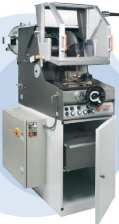
Troncatrici a tre assi con basamento, TR100S a sviluppo verticale e TR100L a sviluppo orizzontale, entrambe adatte per taglio di grandi particolari grazie al carro longitudinale. Struttura in acciaio inox, coperchio in plexiglas, componenti in acciaio inox e ghisa rivestita con nichel chimico, motore mola in ghisa e trasmissione mediante cinghia Poly-V. Refrigerante contenuto in una vasca carrellata alloggiata nel basamento.
