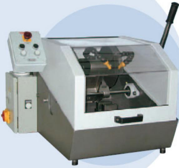
Troncatrici da banco e con basamento di grande potenza, con ampia area di lavoro e passaggio barra bilaterale. Struttura in acciaio inox, coperchio in plexiglas, componenti in acciaio inox e ghisa rivestita con nichel chimico, motore mola in ghisa e trasmissione mediante cinghia Poly-V. Refrigerante contenuto nel corpo macchina o in una vasca inox carrellata all'interno del basamento. Grande assortimento di accessori e attrezzature di fissaggio.
