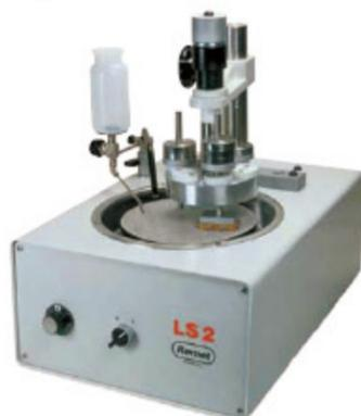
Questi semplici automatismi meccanici possono essere applicati su qualsiasi pulitrice e permettono di risolvere in modo economico la preparazione simultanea di più campioni metallografici.
